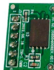
Moduł pamięci alibi - bezpieczeństwo i automatyczny rejestr kopii pomiarów Ze względu na konieczność montażu pamięci alibii w fabryce, opcje można kupić tylko z wagą.
